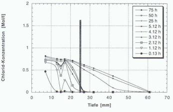
Von besonderem Interesse ist die Angabe der auslösenden kritischen Chloridkonzentration im Verhältnis zum Zementgewicht zum Zeitpunkt der Depassivierung. Diese kann nicht direkt angegeben werden, sondern muss indirekt über Massen-/Volumenbilanzen bestimmt werden. Der folgende Rechnungsgang soll als Hinweis dienen, wie solche Abschätzungen im Prinzip vorgenommen werden können.
