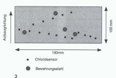
Schematischer Schnitt durch einen Mörtelprüfkörper
