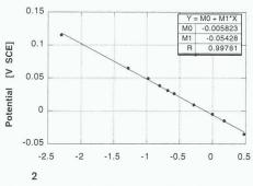
Eichgerade der Chloridsensoren in synthetischer Porenflüssigkeit, hergestellt gemäss der Porenwasseranalyse eines Mörtels mit W/Z = 0,75. Die Messpunkte stellen Mittelwerte aus Messungen an 8 Sensorelementen dar. Oben rechts sind die Werte für Achsenabschnitt, Steigung und Korrelationskoeffizient angegeben
