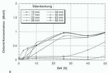
Zeitlicher Verlauf der Konzentration der freien Chloride im Porenwasser in verschiedenen Tiefenlagen eines Mörtelprüfkörpers während eines Aufsaugversuchs mit 3 Mol/I NaCI-Lösung
