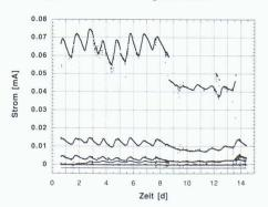
und wieder am Bauwerk eingesetzt. Damit lässt sich unter realen Einwirkungen die Veränderung des freien Chloridgehalts sowie des elektrischen Betonwiderstands im Tiefenprofil mit der Zeit verfolgen.
