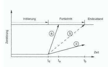
Allgemeines Schema des zeitlichen Ablaufs der Korrosion von Stahl in Beton [ 4 ].  $t_d$ : Zeitpunkt der Depassivierung;  $t_a$ ,  $t_b$ : Erreichen des Endzustands bei Korrosionsgeschwindigkeit a, b; a, b, c: Korrosionsgeschwindigkeiten a > b > c
