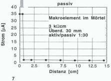
Stromausbreitung bei lokaler Korrosion: Vergleich der Resultate am Modell-Makroelement mit Simulationsrechnungen
