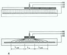
Die geometrische Anordnung von Arbeitselektrode (AE) und Gegenelektrode (GE) bestimmt das elektrische Feld: a) homogene Stromverteilung, b) inhomogene Stromverteilung
