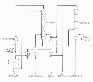
2 Gekoppelte Kolonnen mit elektrisch betriebenem Verdichter
