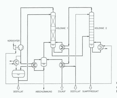
Gekoppelte Kolonnen mit dampfbetriebenem Verdichter
