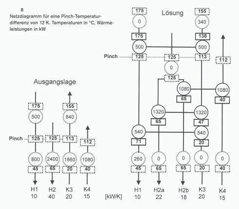
Ausgangssituation in etwas vereinfachter Darstellung. Wir erkennen darin von links nach rechts die vier Ströme H1, H2, K3 und K4 unseres Beispiels mit den Ein- und Austrittstemperaturen (in °C) in rechteckigen Kästchen. Alle heissen Ströme werden von oben nach unten und alle kalten in umgekehrter Richtung eingezeichnet. In den Kästchen in der Mitte sind die Temperaturen am Pinch eingetragen. In
