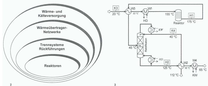
Zwiebelschalenmodell: hierarchisches Vorgehen für die Prozessintegration
