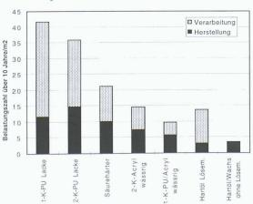
se allergieauslösenden Stoffe (Isocyanate). Sie weisen in der Regel gute chemische und mechanische Beständigkeiten auf. Extreme Belastungen wie in Eingangsbereichen von Schulhäusern oder Gaststätten vertragen diese Lacke genauso wenig wie die wässrigen Siegel. DD-Lacke sind sehr stark umweltbelastend (Bild 1).
