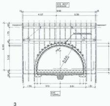
Tunnel- und Baugruben-Querschnitt
