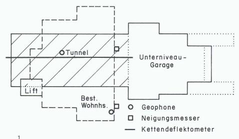
Situation mit Anordnung des Überwachungssystems
