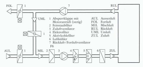
Aussenluftvolumenstrom ist, während er sich in Rezirkulationslüftungsanlagen aus einer temperaturabhängigen Mischung von Aussen- und Umluft zusammensetzt.
