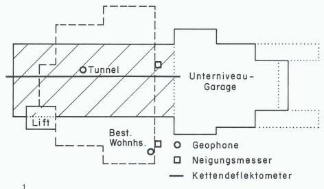
Situation mit Anordnung des Überwachungssystems
