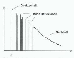
Schematisierte Raumimpulsantwort, x-Achse: Zeit, y-Achse: Schallpegel [4]
