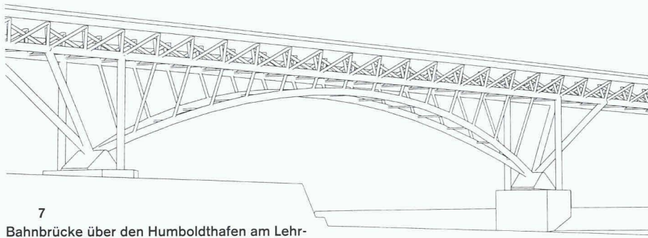
7 Bahnbrücke über den Humboldthafen am Lehrter Bahnhof in Berlin (D) – Erstentwurf Schlaich
