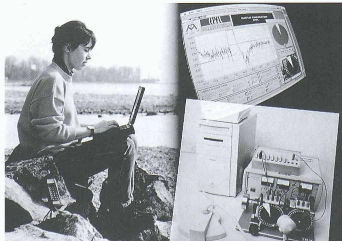
**Visionen werden Wirklichkeit:** Die Studentin ist via Internet mit dem Forschungslabor der Hochschule verbunden. Per Tastatur erteilt sie dem dort installierten Elektromotor Befehle. Auf ihrem Bildschirm kann sie die Versuchsanlage überblicken, Messinstrumente ablesen und die Wirkung ihrer Eingriffe beobachten (Bild: H.R. Bramaz, Zürich © Schweiz. Nationalfonds, Bern)
