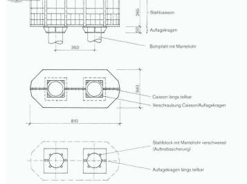
6 Ansicht und Grundriss des Stahlcaissons für das Pfeilerbankett
