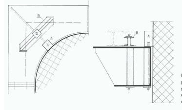
5 Detail der am Bohrpfahl liegenden Kragenverankerung, die als Auflager für den Caisson diente
