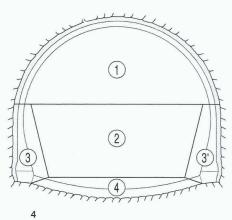
Unterteilung des Querschnitts des neuen Tunnels 2 für die Teilausbrüche
