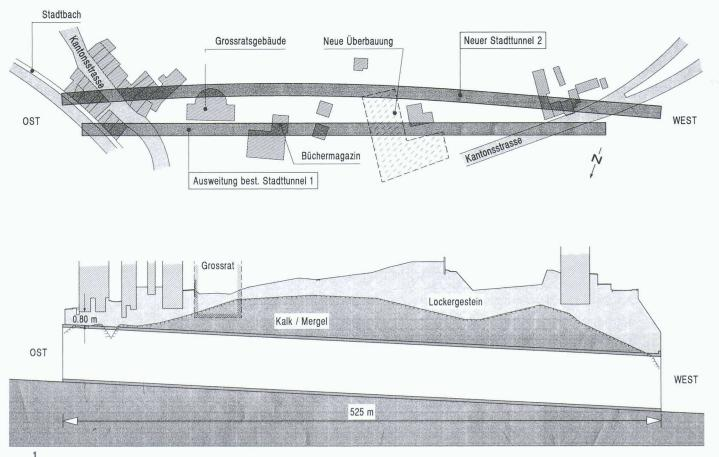
Situation der beiden Tunnel und Längsschnitt neuer Tunnel 2
