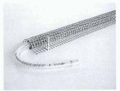
Das neue Arbeitsfugenband enthält zusätzlich einen Injektionskanal. Dieser wird nur im Bedarfsfall benutzt. Der Zeitpunkt einer Prüfung der Arbeitsfuge auf Dichtigkeit kann nun selber frei gewählt werden
