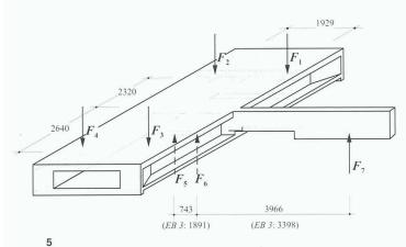
Belastungs- und Lagerungskonzept. Abmessungen in mm
