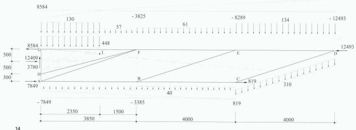
Diskontinuierliches Spannungsfeld. Kräfte in kN, verteilte Lasten in kNm<sup>-1</sup> und Abmessungen in mm
