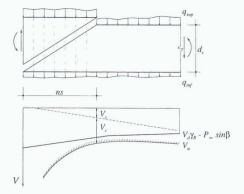
12 Vergleich der Resultate der Modellversuche [6,7] mit Vorhersagen von Stegdruckbruchmechanismen
