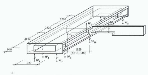
Durchbiegungsmessungen. Abmessungen in mm
