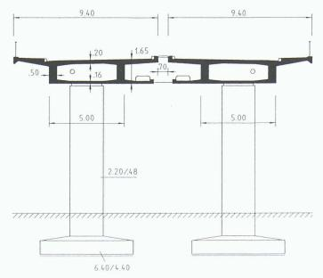
Typischer Brückenquerschnitt. Die Querträger über den Stützen verbinden die beiden Brücken
