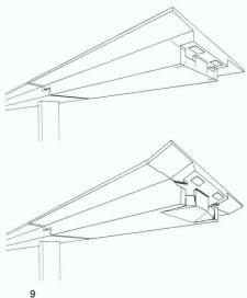
Bruchmechanismus der Auflagerkonsole eines Einhängeträgers. Oben: unverformter Einhängeträger mit theoretischem Rissbild, unten: verformte Lage des räumlichen Bruchmechanismus (man beachte die Aussparungen im Querträger für die Zugänglichkeit der Lager)
