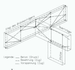
Statisches Modell für die Nachrechnung der Schubtragfähigkeit im Übergang Steg-Querträger
