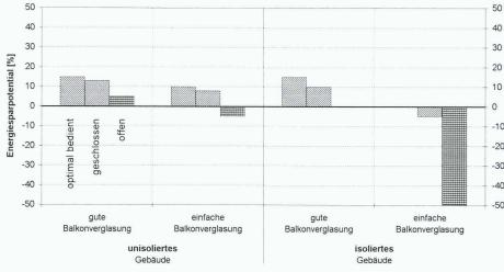
2 Energiesparpotential eines Gebäudes mit südseitigen verglasten Balkonen in Abhängigkeit
