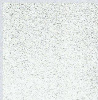
Die Oberfläche besteht aus reinem Zinn, das wie das Trägermaterial Kupfer eine ausserordentliche Beständigkeit gegen atmosphärische Einflüsse hat.
