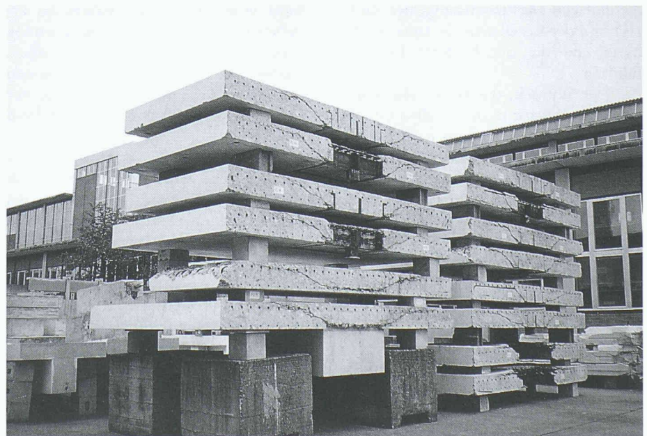
Bruchbild in den zentrisch durchgeschnittenen Versuchskörper
