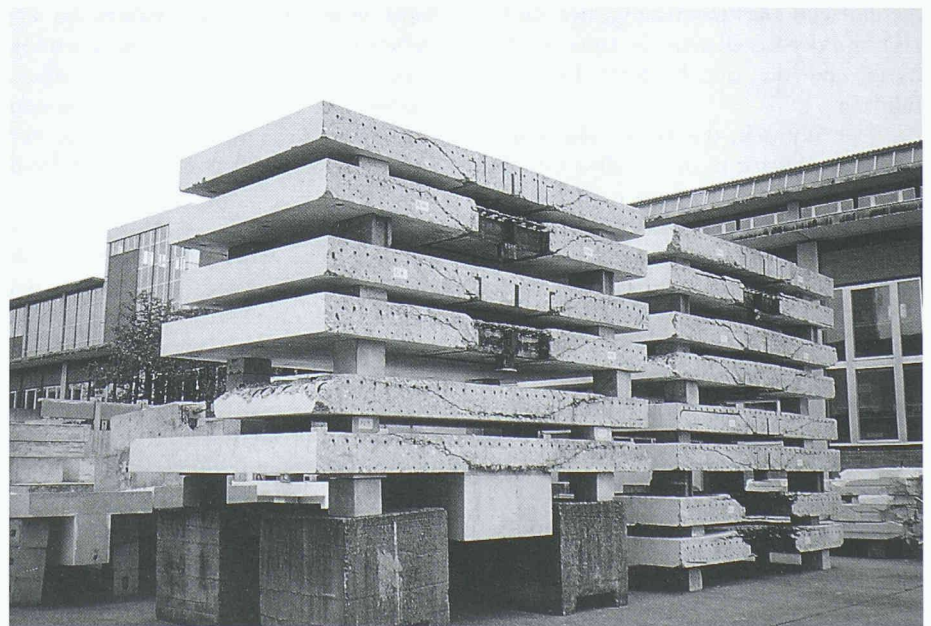
Bruchbild in den zentrisch durchgeschnittenen Versuchskörper
