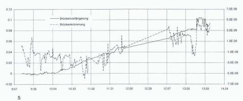
Verlängerung [mm] der Brücke auf einer Länge von 2 m (linke Ordinate) und Krümmung [1/mm] beim Nordpfeiler (rechte Ordinate). Auf der Abszisse die Uhrzeit
