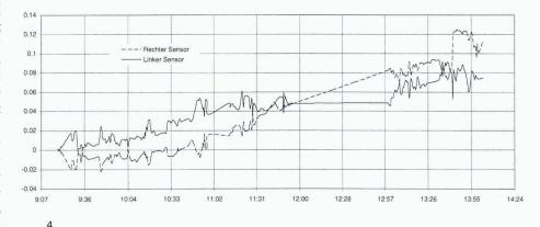
Verlängerung bzw. Verkürzung [mm] der Glasfasersensoren beim Querverschub. Auf der Abszisse die Uhrzeit
