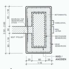
Schematischer Querschnitt des Pfeilerflanschs
