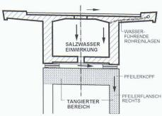
Das von der Fahrbahn stammende Salzwasser gelangte durch den undichten Einstieg in den Brückenkasten und von dort an den Pfeiler
