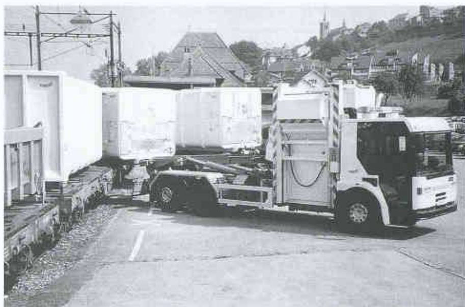
Integrales Entsorgungssystem Translift beim Direktumschlag des Sammelcontainers vom Sammelfahrzeug auf die Bahn. Der Umschlag kann vom Fahrer alleine, ohne Hilfsmittel oder zusätzliches Personal, bewerkstelligt werden
