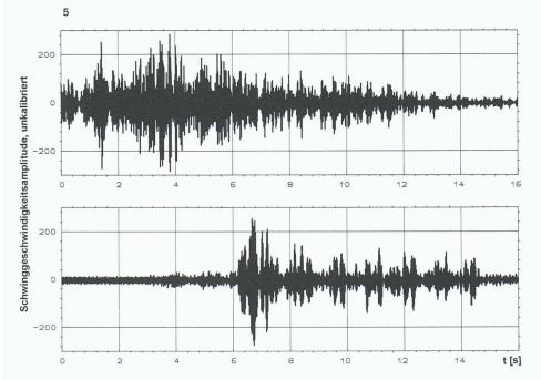
4 Lokomotive, Fahrtrichtung Stollen – Tunnel. Obere Grafik: Körperschallsignal am Immissionsort, untere Grafik: Körperschallsignal am Energiestollen
