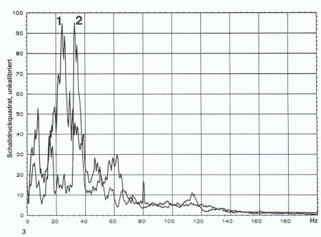
Frequenzspektrum des Körperschalls, der auf das Fundamentmauerwerk am Immissionsort einwirkt, Kurve 1. Frequenzspektrum des sekundären Luftschalles am Immissionsort, Kurve 2
