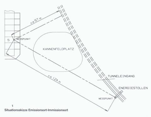
ein Signal auftreten, nicht aber gleichzeitig am Immissionsort. Dieses tritt erst bei der Einfahrt des Zuges in den Tunnel auf. Bei Zügen mit 40 km/h nach 1,8 s und bei Zügen mit 60 km/h nach 1,2 s (Strecke Stollen bis Einfahrt Tunnel 20 m).
