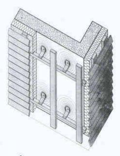
Unterkonstruktion in Stahl oder Aluminium mit Konsolen und Winkelprofil zur Befestigung des Wetterschildes (Bild: Hans Bertschinger, Empa-KWH)
