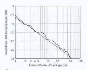
Beispiel einer Messung und Berechnung zur Bestimmung von DL2. Die Auswertung der Messung (dickere Kurve) ergibt hier DL2 = 4,0 dB, das berechnete Ergebnis (dünnere Kurve) beträgt DL2 = 4,1 dB. Die dünne, steil abfallende Kurve stellt die theoretische Abnahme des Schalldruckpegels im Freien dar (DL2 = 6 dB).
