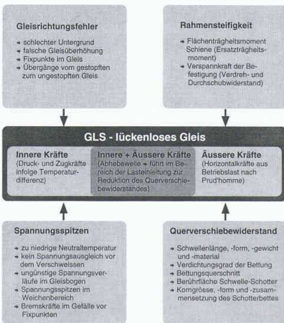
1 Einflussgrössen auf die Gleislagestabilität (= GLS) [3]
