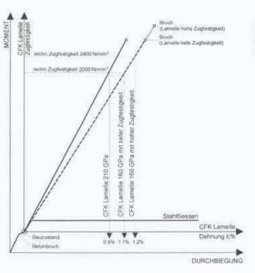
6 Einfluss der CFK-Nachverstärkung auf Durchbiegung des Bauteils
