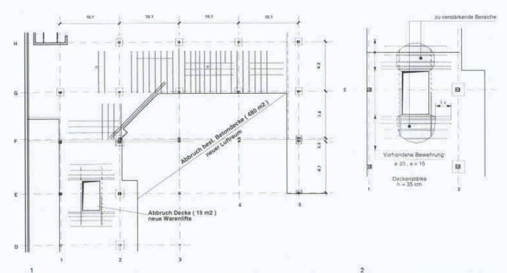
Ausschnitt Decke über 1. UG; Verschiedene Deckenbereiche werden mit CFK-Lamellen verstärkt, da beim Deckenabbruch für die neuen Warenlifte der Gurtstreifen zu ersetzen ist und die früheren Mittelfelder beim neuen Luftraum als Randfelder stärker beansprucht werden.
