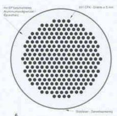
Querschnitt durch die Verankerung der CFK-Kabel
