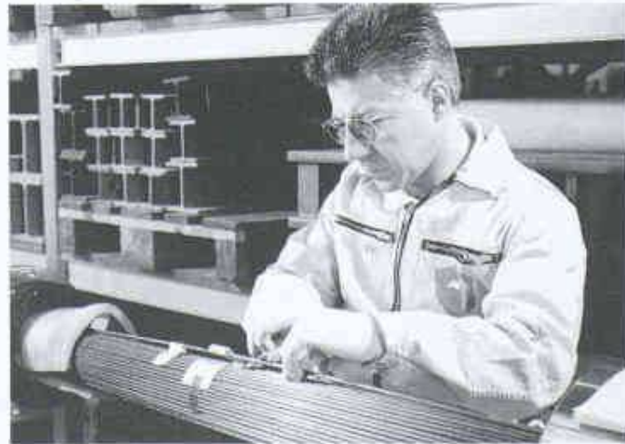
Aufbringen von Sensoren für die Langzeitmessungen
