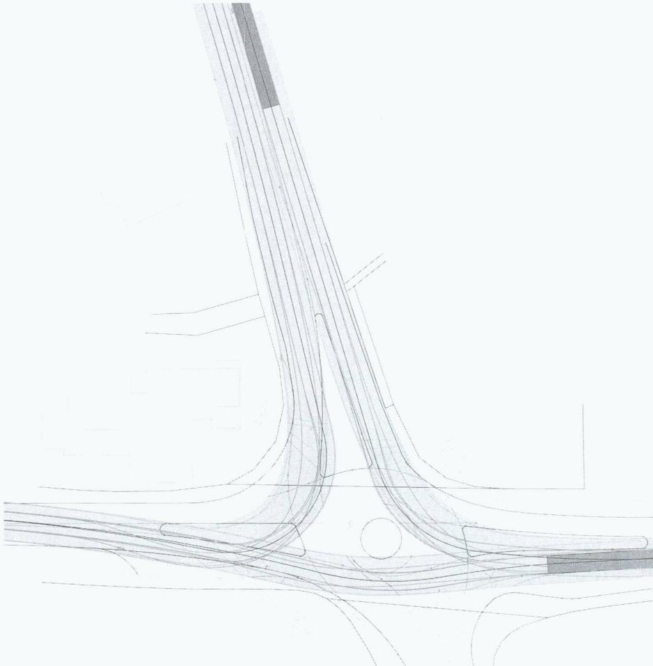
ges den grössten Flächenbedarf ergeben. Danach muss man entscheiden, wo der Führungspunkt des Fahrzeugs ist. Dieser kann je nach den Normen des Landes an einer anderen Stelle liegen. Für die Schweiz muss der Führungspunkt in der Mitte der Vorderachse sein [1]. In Deutschland und Österreich kann er an einer beliebigen Stelle stehen [2] [3].
