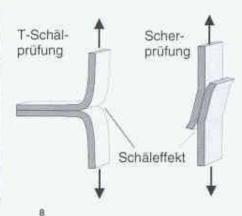
Nahtprüfungen: T-Schälprüfung und Scherprüfung
