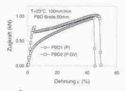
Kraft-Wegdiagramm von PBD im Zugversuch: PBD1 mit Polyestervlies (P) und PBD2 mit Polyestervlies und Glasgittervlies (GV)
