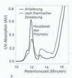
Chromatogramm eines Polymerbitumens vor und nach thermischer Zersetzung
