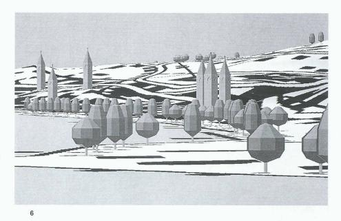
Orts-, Regional- und Landesplanung der ETH Zürich wurden für die dynamische visuelle Simulation eine synthetische, komplett digitale Landschaft aus Orthofoto, digitalem Geländemodell und CAD-Objekten erstellt und Sichtbarkeitsanalysen gerechnet sowie eine Computer-Animation (Videofilm) realisiert (Bild 7).
