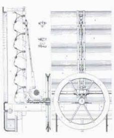
18 Mechanisch verstellbare Lüftungsklappen im Bereich der Gebäudehülle des Londoner Kristallpalastes von Joseph Paxton (1851)
