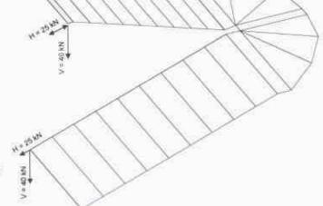
Modell der frei auskragenden Stahltreppe mit den zu erwartenden Kräften für die Treppe aus Bild 3
