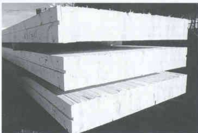
2 Brettstapелеlemente werden vorgefertigt auf die Baustelle gebracht
