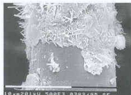
Oben: Verbund aus Zementleim und Glasfasern, rasterelektronenmikroskopische Aufnahme; unten: Zementstein und Calciummineralien haften an den Glasfasern
