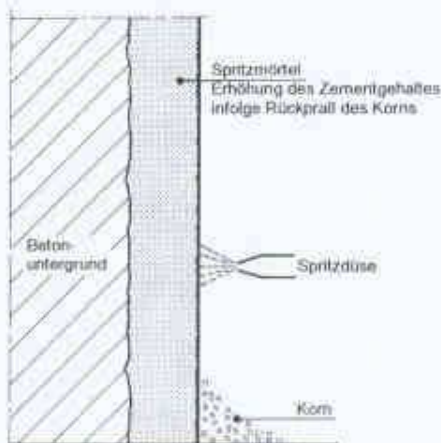
Erhöhung des Zementgehalts infolge Kornrückprall
