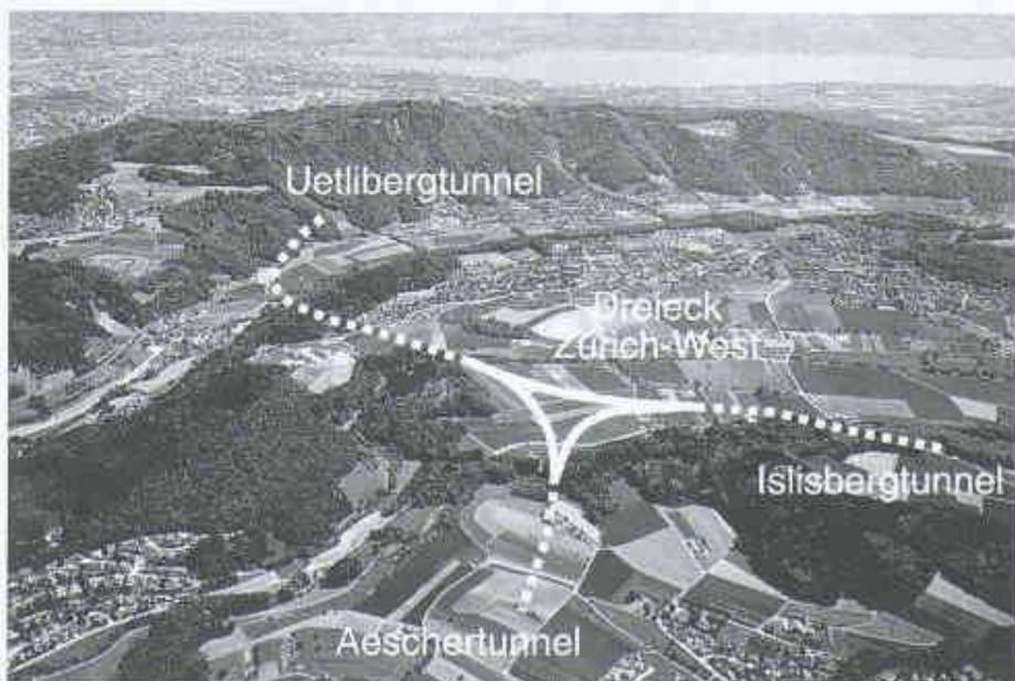
Die Linienführung der Westumfahrung verläuft grösstenteils unter der Erde. Beim Dreieck Zürich-West bei Wettwil käme sie von Aesch
