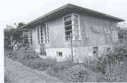
10 Einfamilienhaus in Hallau von Stefan Gerber. Die Fassade bleibt ungeschliffen und unbehandelt. Die natürliche Vergrauung des Holzes ist erwünscht
