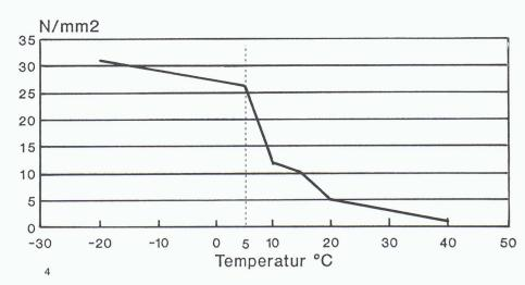
sucht worden. Bei allen Platten wurden die Bruchkräfte bei verschiedenen Temperaturen mit einem Druckstempel einerseits in der Plattenmitte und anderseits am Plattenrand bestimmt.
