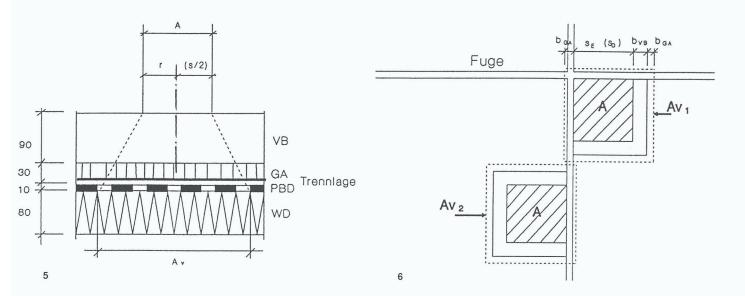
Rand erfolgte bei Temperaturen unter +20°C ebenfalls erst nach dem Bruch des VB bzw. GA. Mit den gemessenen Stempeldruckwerten und aufgrund des Verhaltens des Schaumglases sind für die Dimensionierung der VB-Nutzplatten anschliessend die Lastverteilflächen bestimmt worden.
