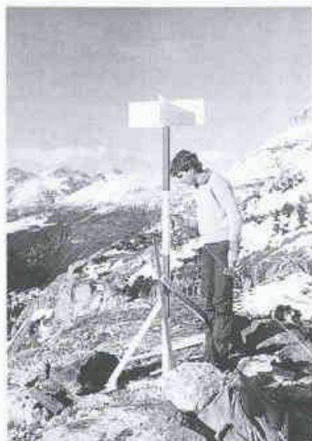
2 Signalisierung der Triangulationspunkte
