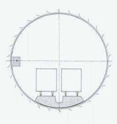
Tunnelquerschnitt mit Sohltübbing und Doppelspurgleis
