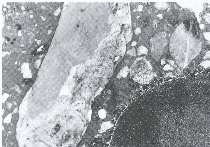
Hydrodynamisch freigelegter Bewehrungsstab ohne erkennbare Verbundstörung
