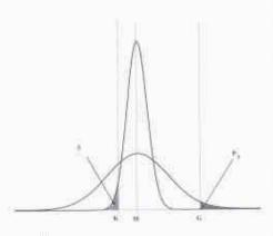
Schematische Darstellung einer einfachen Stichprobenkontrolle Breite Kurve: Verteilung der Lieferung Schmale Kurve: Verteilung des gemessenen Mittelwertes
