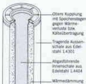
Perfekte SELKIRK Produkt-Konzeption 3-schaliges Aufbau mit Innen- und Außenschale aus hochwertigem Edelstahl, dazwischen der dicke Mineralwoll-Dämmstoff mit hoher Stoßdichte.
