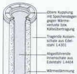
Perfekte SELKIRK Produkt-Konzeption: 3-schaliges Aufbau mit Innen- und Aussenschale aus hochwertigem Edelstahl, dazwischen der dicke Mineralwoll-Dämmstoff mit hoher Stoßdichte.
