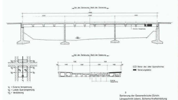
schlaffer Bewehrung erfolgte. Die sehr hohe Vorspannung führte dann zu Zwängungen, so dass über den Stützen Risse auftraten und die Durchlaufwirkung teilweise verloren ging. Das ursprüngliche Fehlen einer Standspur auf der rund 400 m langen Brücke erwies sich zudem als betrieblicher Nachteil angesichts des stetig zunehmenden Verkehrsvolumens auf der
