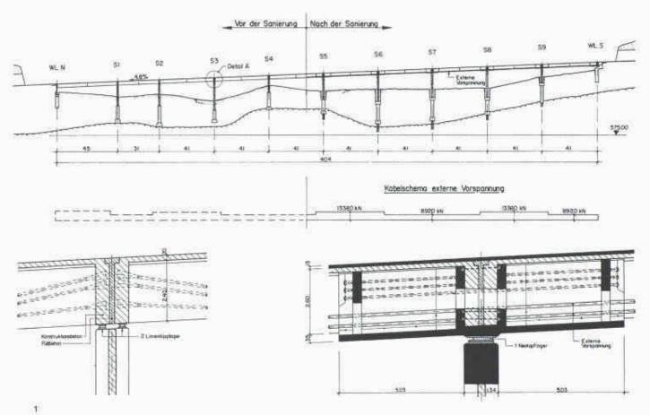
Sanierung Lehnenviadukt Höll der N2: Längsschnitt (oben) und Stützendetails (unten links alt, rechts saniert)
