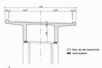
Sanierung Lehnenviadukt Höll der N2: Alter und sanierter Überbauquerschnitt
