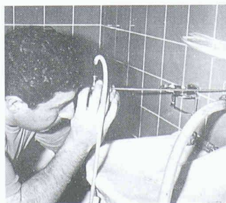
Das Rohrinne wird mit dem Endoskop kontrolliert
