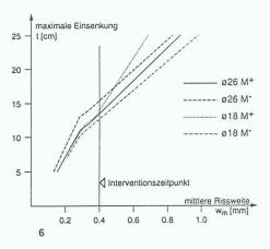
Einsenkungs-Rissweiten-Diagramm für Normsenkung Form 1,  $k = 5 \cdot 10^4 \text{ kN/m}^3$  und verschiedene Bewehrungsdurchmesser
