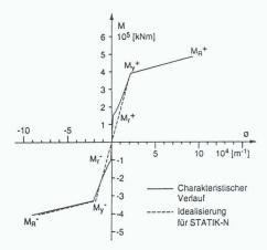
Normdoline und mit Lasten auf Gebrauchsniveau. Durch eine schrittweise Steigerung der Senkung bis zum Maximalwert konnten die Ausbildung der plastischen Gelenke und das lokale Abheben der Tunnelröhre simuliert werden.
