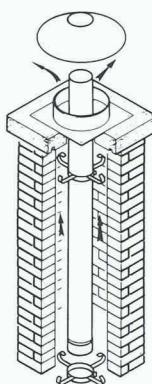
Diese einzigartige, temperatur- und säurebeständige Spezialdichtung ist das unverwechselbare Kennzeichen unseres Supra-Systems. Zum unverwüstlichen Edelstahl kommt die Dichtigkeit des Gesamtsystems. Perfekter Schutz gegen Kondensat in Kesselanlagen mit Brennwertbetrieb oder besonders niedrigen Abgastemperaturen.
