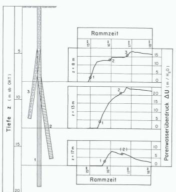
Porenwasserüberdruck  $\Delta U$  in der Tiefe z = 8,13 und 17 m bei der Rammuna des Fertiabetonpfahls Cl und mutmassliches Bruchbild des Pfahls, welcher eine scheinbare Länge von 36 m erreicht hat. Ein wiederholter Porenwasserdruckanstied zeigt, dass der Pfahl die Druckgeber der gleichen Tiefenstufe mehrfach passiert haben muss und die drei Abschnitte des 2fach gekuppelten Pfahls folglich nebeneinander liegen müssen.
