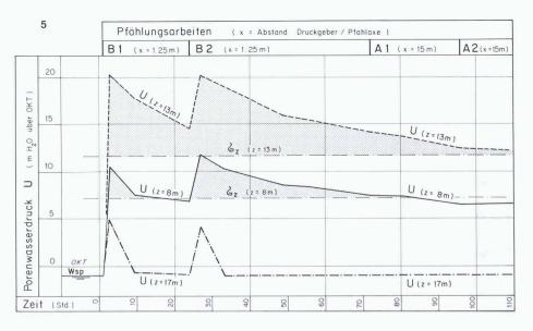
der Porenwasserdruck in sensitiven Böden in etwa 1 m Abstand neben dem Pfahl dem vollen totalen Überlagerungsdruck entsprechen. Gautschi [2] hat im Abstand von rund 2 m neben Holzpfählen in tonigem Silt Porenwasserdrücke in der Grössenordnung von 90% des totalen Überlagerungsdrucks beobachtet.
