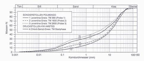
Bild 2. Siebkurven der untersuchten TBM-Rohmaterialien
