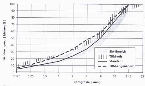
Bild 3. Siebkurven der Betonzuschläge bei den Ortbetonuntersuchungen
