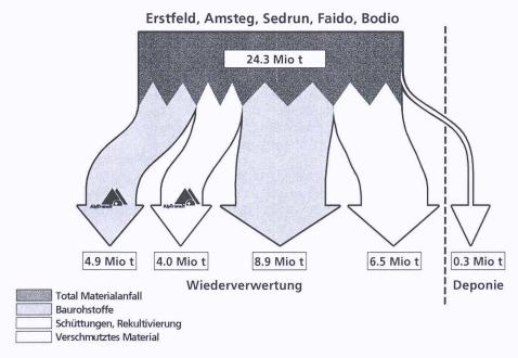
Bild 2. Materialbilanz Gotthard-Basistunnel
